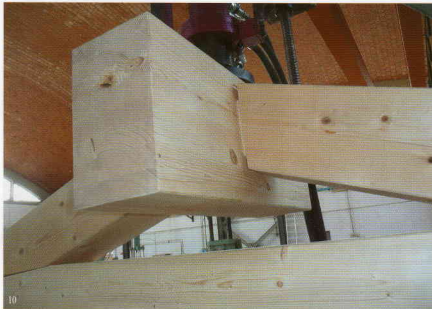
10. Particolare della rotazione del nodo di colmo in fase di rottura.
