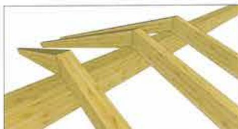
*Esempi di connessione tra elementi di legno nella costruzione dei tetti. Fare attenzione: ogni connessione deve essere avvita come mostrano le figure seguenti*
