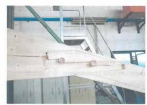
lari, confezionati con cavicchi ed anche su solai con solette solidarizzate con cavicchi, come nella sperimentazione su di un solaio con travi principali 14x19cm, soletta di 5cm di tavole incrociate fra loro solidarizzati con cavicchi legno di faggio eseguita presso lo stabilimento Barel Legnami di Conegliano, constatando sempre l'ottimo e sorprendente comportamento.
